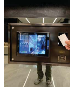
รูปที่ 8 แสดงตำแหน่งการแตะบัตรเพื่อนำรถออก และจอ LED แสดงสถานะและคิวรถ
